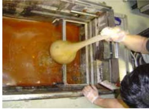
ネットホルダーからスクムセーブネットを外して口の部分を片結びします。
